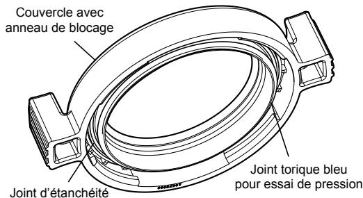
**Figure 4. Joint torique bleu pour essai de pression et assemblage pour couvercle**
