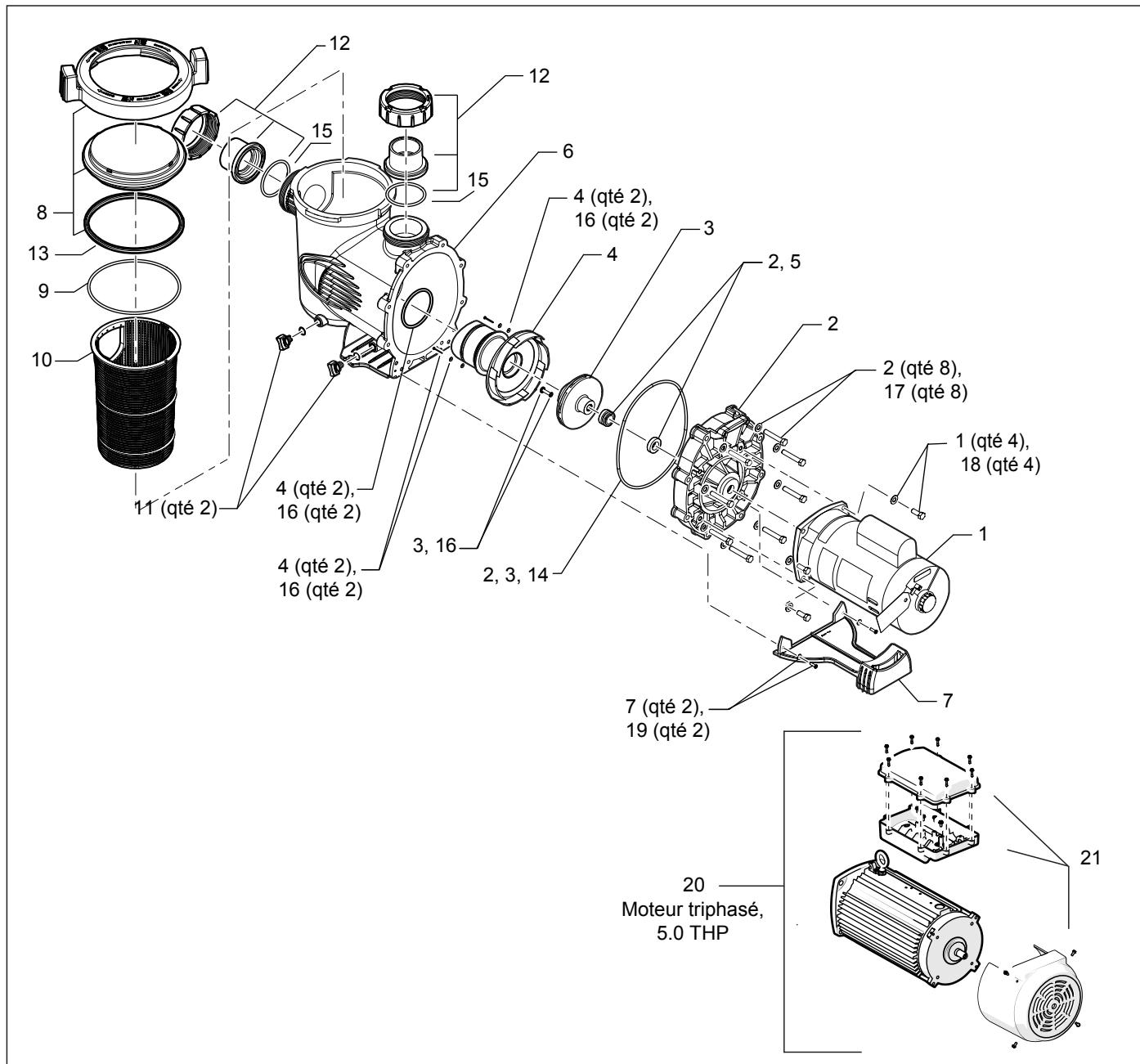
Figure 6. Vue éclatée du modèle SHPF et SHPM
