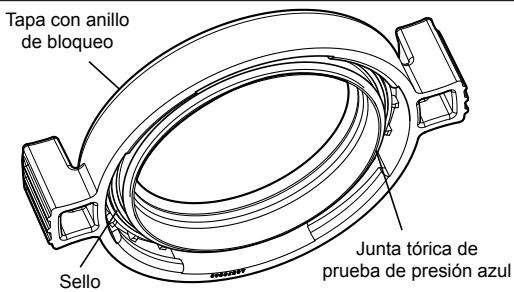
**Figura 4. Conjunto de la junta tórica de prueba de presión azul en la tapa**
