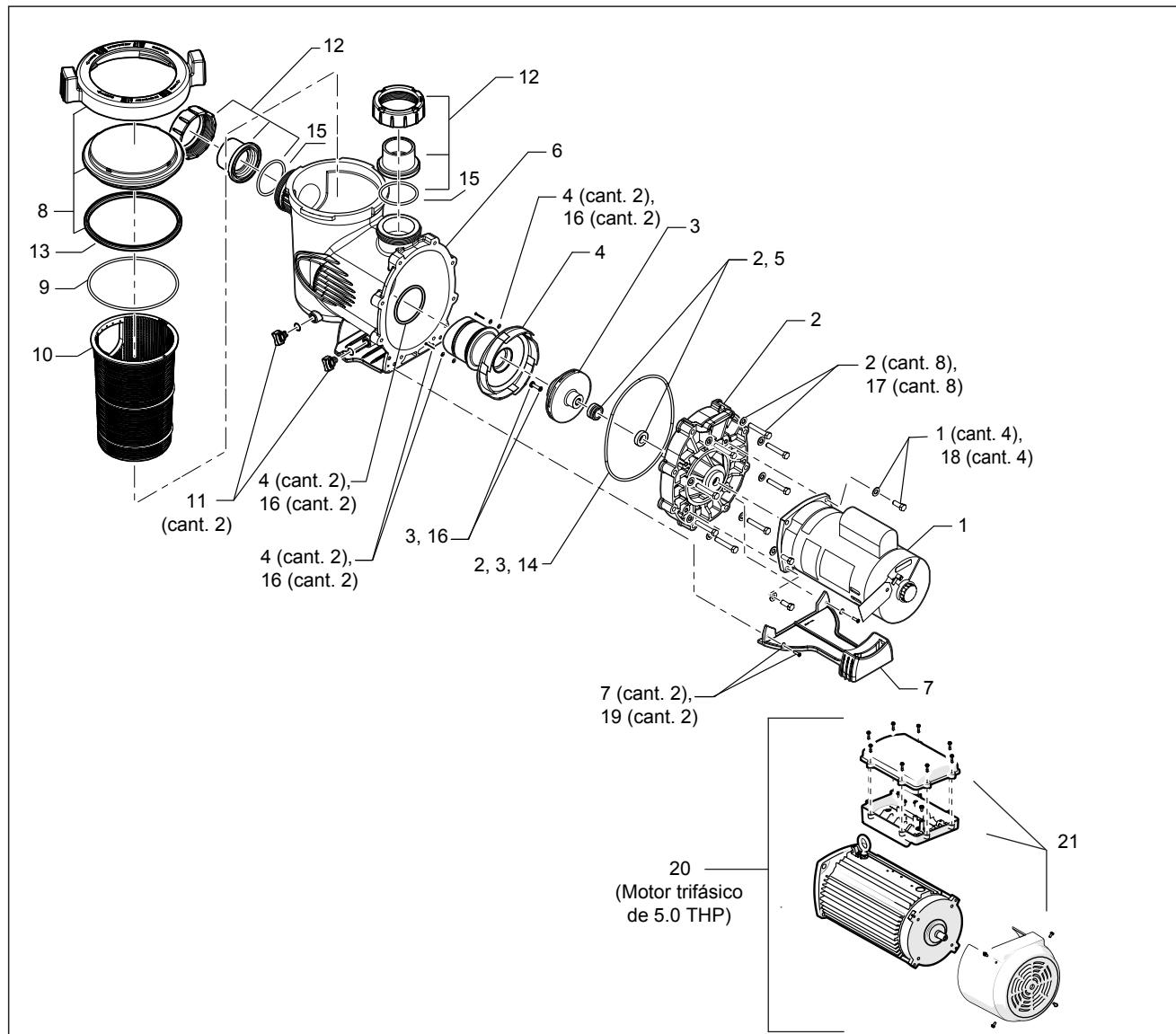
Figura 6. Vista ampliada de SHPF y SHPM
