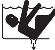
**PELIGRO DE SUCCIÓN.** Puede provocar lesiones graves o la muerte. No use esta bomba para piscinas infantiles, piscinas de poca profundidad o hidromasajes que contengan drenajes en el fondo, a menos que la bomba esté conectada por lo menos a dos (2) salidas de succión en funcionamiento.
